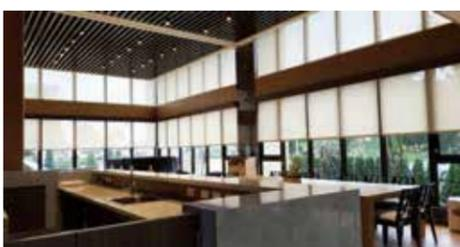
室内外の照度をセンサーでモニタリングしながら、カーテンをコントロールして省エネにつなげる「スマートカーテン」、温湿度や二酸化炭素(CO<sub>2</sub>)濃度を調整するために自動で窓を開閉する「スマートウインドウオープナー」などのシステムだ。
